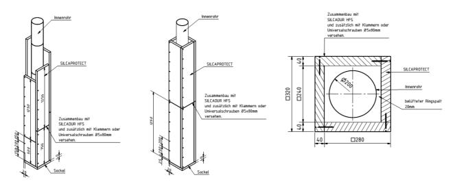
Öffnungen für z.B. Reinigungstüren und Anschlussmöglichkeiten der Feuerstätten können einfach mit handelsüblichen Holzbearbeitungsmaschinen in die betreffenden Platten geschnitten werden.
